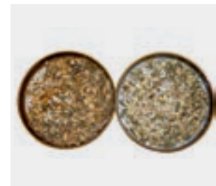
Ситовой анализ технологии SHREDLAGE с высокой интенсивностью обработки зерна справа и традиционной технологии обработки силоса слева
