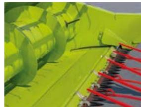
Стол жатки выдвинут – уборка зерновых (+100 мм)
