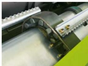
Обычные наклонные камеры работают с транспортерными цепями. В новой камере вместо цепей для соединения подающих пластин используются зубчатые ремни. Они приводятся в действие посредством зубчатого зацепления. Таким образом обеспечиваются мощная подача даже большого количества материала и мощное реверсирование. По сравнению с обычной наклонной камерой ременный транспортер имеет существенные преимущества:
