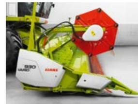
Стол жатки выдвинут – уборка зерновых (+600 мм)
