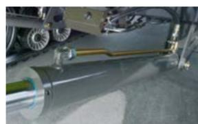
Цилиндры жатки двойного действия точно регулируют давление на почву.
