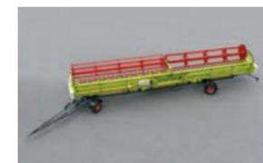
Двуосная транспортная тележка с управляемой задней осью
