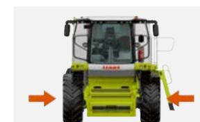
Сниженная транспортная ширина при увеличенной опорной поверхности
