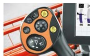
Кнопка регулировки высоты на многофункциональном джойстике позволяет с легкостью включить автоматику жатки.
