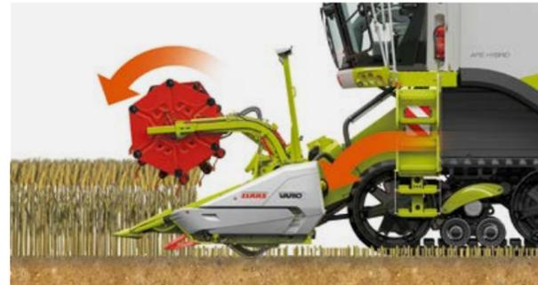
Сравнение фактического состояния с заданными значениями позволяет адаптировать жатку к рельефу, что обеспечивает существенное облегчение труда, в особенности при использовании жаток с большой шириной захвата, а также ночью, на склонах и каменистой почве. AUTO CONTOUR увеличит производительность и сделает работу с LEXION еще более экономичной.
