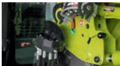
Мультисцепка MACH – самый быстрый способ осуществить соединение.
