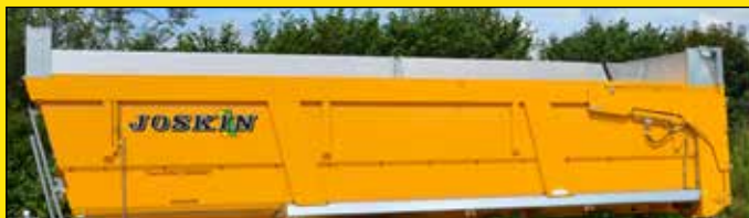
Комбинация алюминиевых надставных бортов и одного гидравлического стального надставного борта (50 см)
