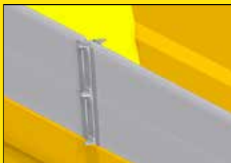
Система складывания надставных бортов
