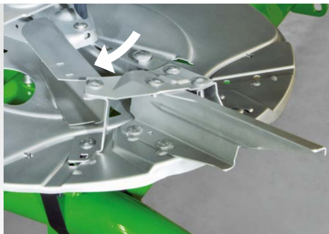
AutoTS – настройка направляющей лопатки для пограничного распределения
