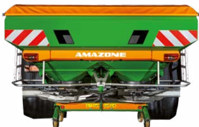
Насадка L 3200 (ширина заполнения 2,71 м) со складными лестницами
