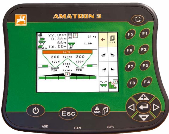
AMAZONE AMATRON 3 Дисплей диагональю 5,6"
