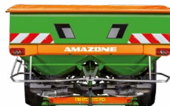
Насадка S 2600 (ширина заполнения 2,22 м) со складной лестницей слева по направлению движения
