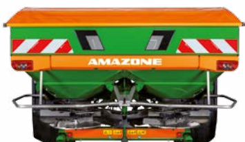
Насадка S 2000 (ширина заполнения 2,22 м)
