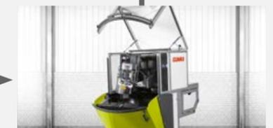
Затем заточить оба комплекта ножей с помощью AQUA NON STOP COMFORT по уникальной технологии мокрой шлифовки.
