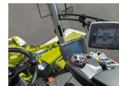
Удобное управление с помощью совместимого с ISOBUS терминала COMMUNICATOR II или S10 и функциональных клавиш ISOBUS на рычаге управления.
