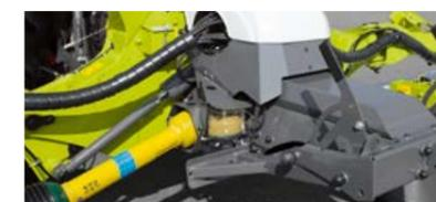
Предлагаемая в качестве опции автоматическая централизованная смазочная система призвана облегчить ежедневное техническое обслуживание.
