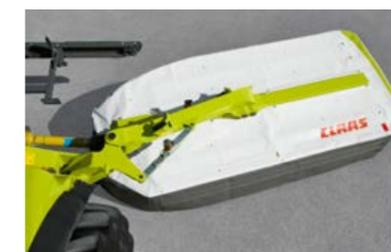
Отщелкивание механической защиты от столкновений: при столкновении секция отклоняется назад и автоматически приподнимается.
