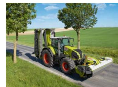
Компактное положение при транспортировке для безопасного движения по дороге.
