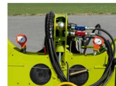
Гидравлический разъем KENNFIXX® с маркировкой муфты и гидравлической блокировкой при транспортировке.
