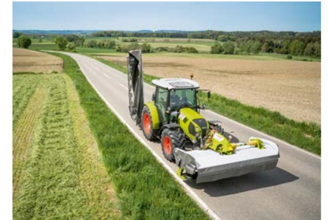
Компактное положение при транспортировке.
