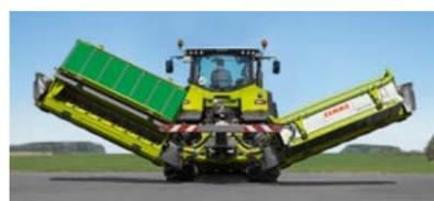
Подъем по отдельности на краю поля и индивидуальное складывание отдельных лент обеспечивает профессиональная система управления.
