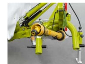
Для простоты установки прицепные пальцы расположены на разной высоте.
