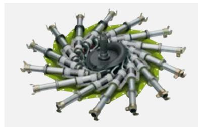
Роторное колесо CLAAS в герметичном корпусе с постоянной смазкой и креплением граблей PROFIX для максимальной надежности.
