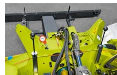
Очень легкий ход ACTIVE FLOAT: манометр для простой регулировки давления прижима обоих косилочных механизмов.
