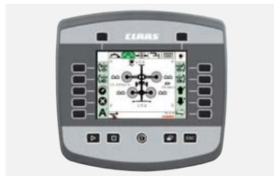
Управление осуществляется с помощью COMMUNICATOR II, любого другого совместимого с ISOBUS терминала или очень просто с помощью терминала OPERATOR.
