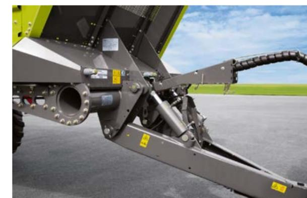
подъема дышла ускоряется процесс выгрузки – идеальное решение прежде всего для разгрузки остатков. При необходимости также можно увеличить силу тяги, так как колеса прицепа перемещаются рядом с трактором.
