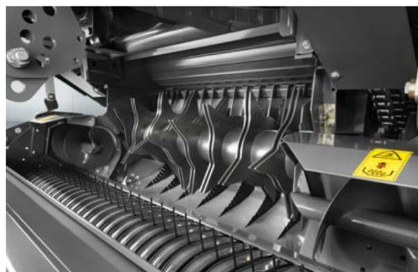
Режущая система ROTO CUT.
