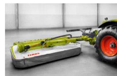
Стрелы с гидравлическим управлением позволяют (в зависимости от передненавесной косилки) устанавливать ширину захвата от 9,40 до 10,70 м.
