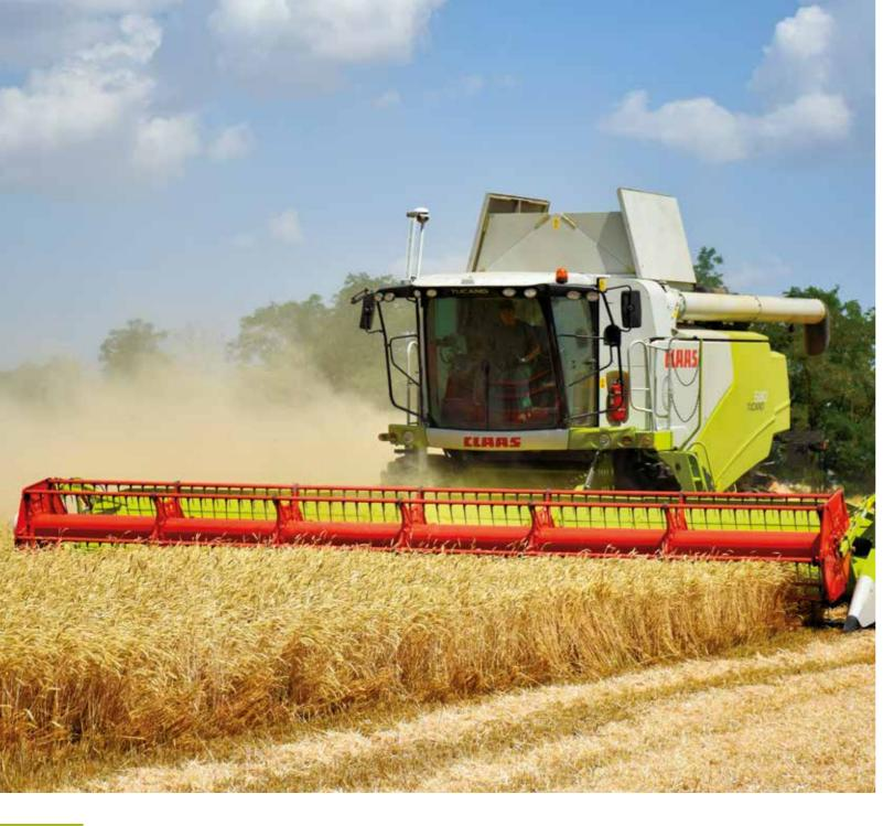
повышать производительность комбайна, а при работе с гибридной машиной изменять интенсивность сепарации. На качество сепарации, а значит, и степень потери зерна за ротором можно воздействовать повышением либо снижением оборотов ротора (на машинах CLAAS последних годов выпуска это возможно с помощью вариатора, управляемого через CEBIS, на более ранних моделях – путем перестановки приводных шкивов ротора).
