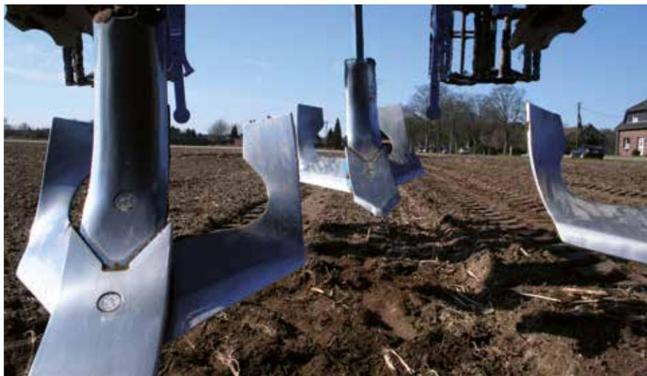
Новый стерневой культиватор Kristall компактной конструкции от ЛЕМКЕН может осуществлять на разных этапах как поверхностную, так и обработку на среднюю глубину. При поверхностной обработке в первый проход стрельчатые лапы «Три-Микс» специальной формы осуществляют сплошную обработку и заделывают падалицу и органическую массу неглубоко в почву. Семена падалицы остаются в верхнем слое почвы и быстро прорастают.
