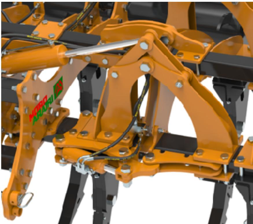
Плотное прилегание складывающейся конструкции к основной раме обеспечивает система массивных стальных зажимных крюков. Как при зацеплении, так и при расцеплении крюков они приводятся в действие автоматически. Конструкция устройства блокирования такова, что при его работе устраняются и все люфты, и при любых условиях прилегание остается плотным.
