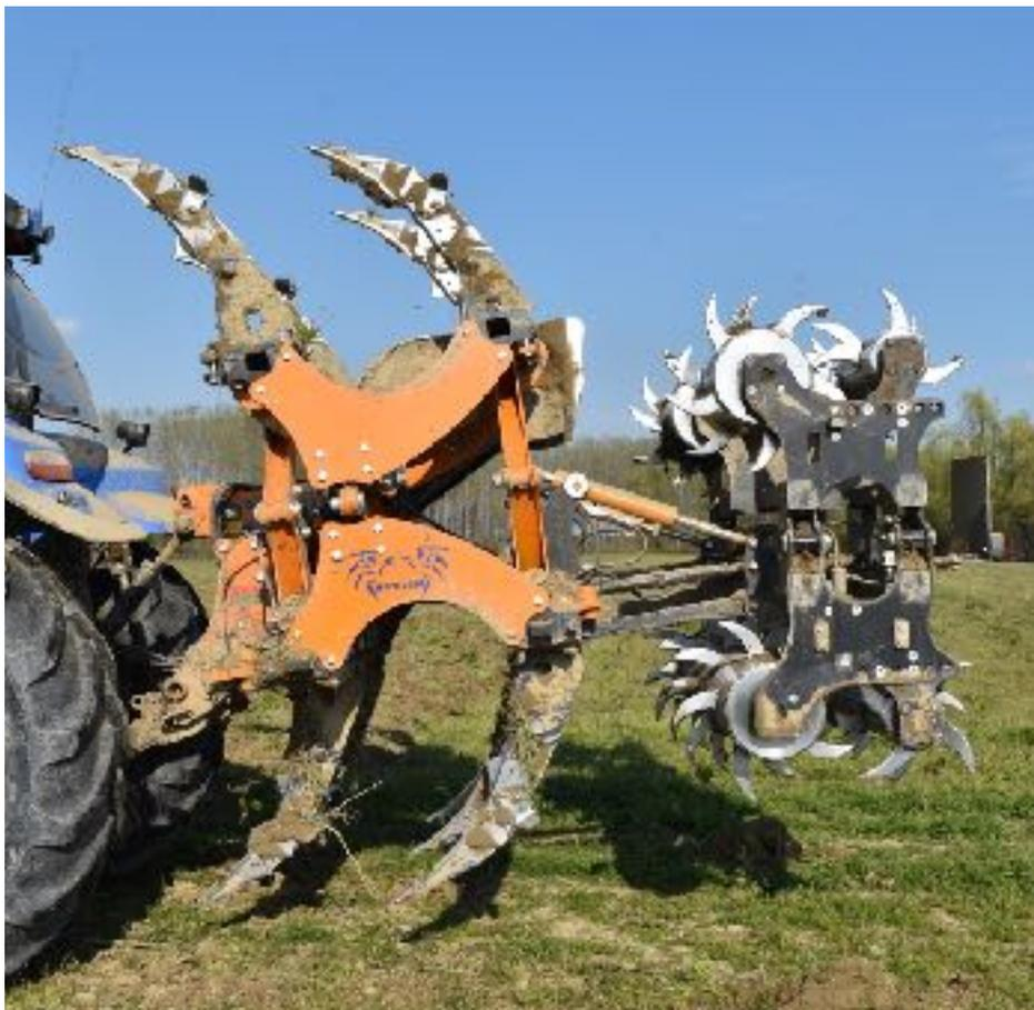
Глубокорыхлитель “SPIDER X” может использоваться как самостоятельная машина или в комплекте со специальными спаренными катками “RCX”; регулировка глубины работы имеет гидравлический привод. Передний каток имеет диаметр 360 мм, а задний – 220 мм; они хорошо крошат почву и выравнивают ее поверхность, на ней не остается характерных бугров, которые бывают видны при работе глубокорыхлителей с катками меньших диаметров.
