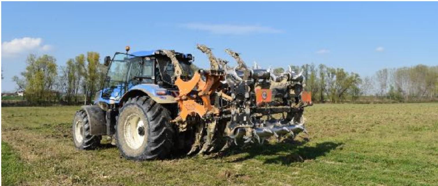
Глубокорыхлитель “SPIDER X” предлагается для версий на 7, 9 и 11 лап. Двойная система складывания с поворотом на 180° позволяет уменьшить транспортные габариты машины до 2,5 метров. В рабочем положении рама с рабочими органами жестко и надежно фиксируется специальными крюками-зажимами, что очень важно, когда машина агрегируется с трактором повышенной мощности и при ее интенсивной эксплуатации.
