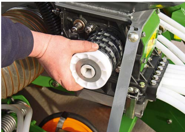
Замена дозирующей катушки
