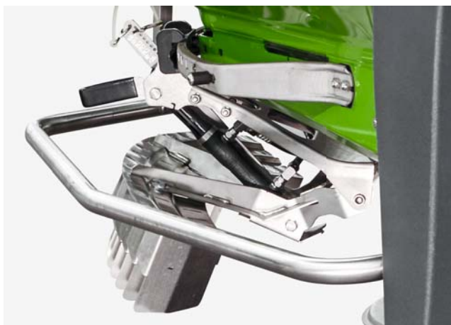
Гидравлическое приспособление для пограничного распределения Limiter V
