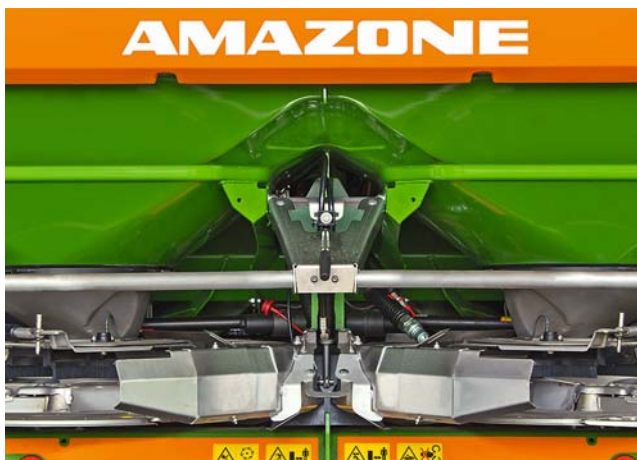
Опущенный с обеих сторон рядовый щиток с телескопически выдвигаемыми наконечниками
