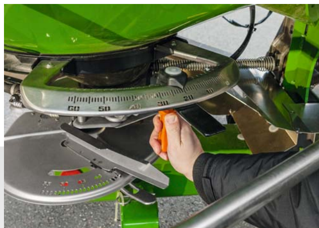
Простая регулировка консоли заслонок
