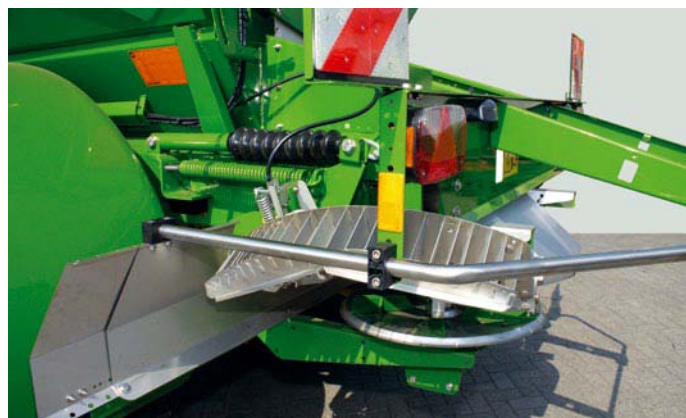
Система пограничного распределения Limiter в приподнятом положении для нормального распределения
