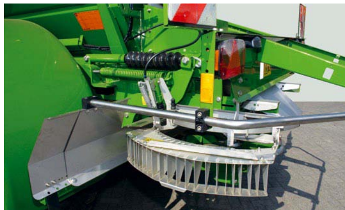
Система пограничного распределения Limiter в рабочем положении
